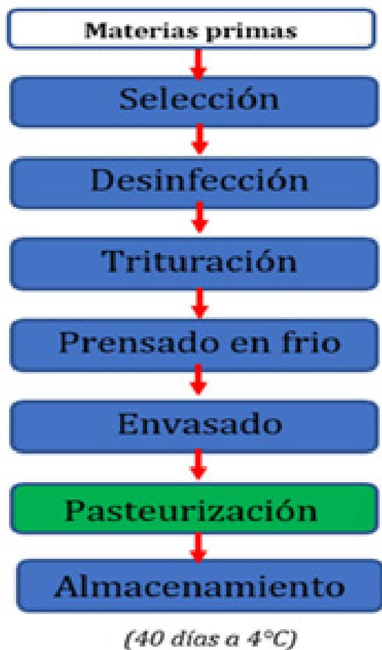
**Figura 2.** Diagrama general del proceso de elaboración industrial de los jugos *détox*.
